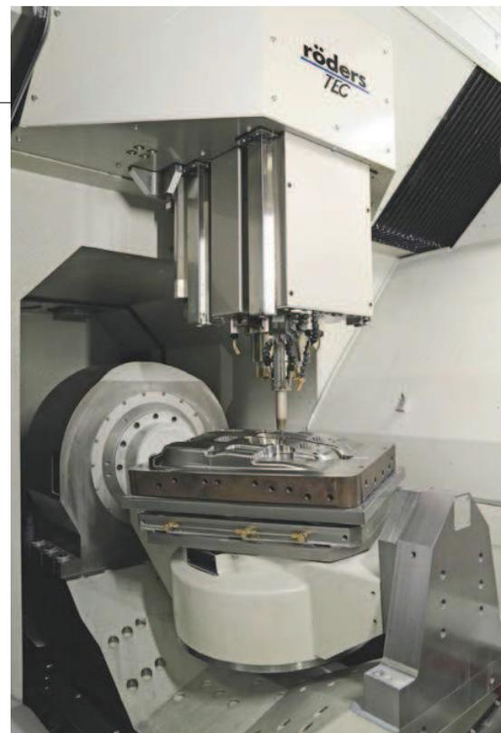
Fresatura in alta velocità di tassello stampo per componente tecnico.
