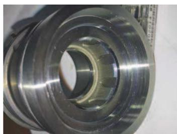
Elettrodo e matrice erosa per la realizzazione di un tappo.
