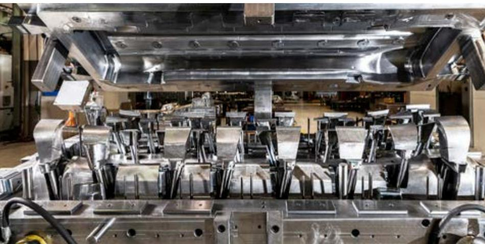
**Dettaglio stampo 1+1 cavità per minigonna realizzato per il settore automotive da Esistampi**
