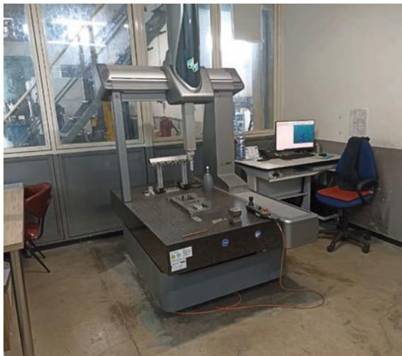
Controllo qualità con macchina di misura Global S di Hexagon
