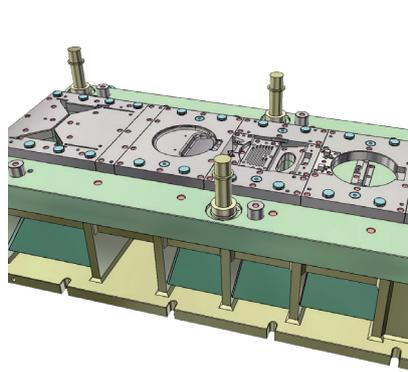
utilizzate per progetti successivi. In questo caso il sistema adatterà le dimensioni dello stampo in base alla striscia in modo automatico. La distinta base dei componenti utilizzati viene generata in automatico in modo dettagliato.
