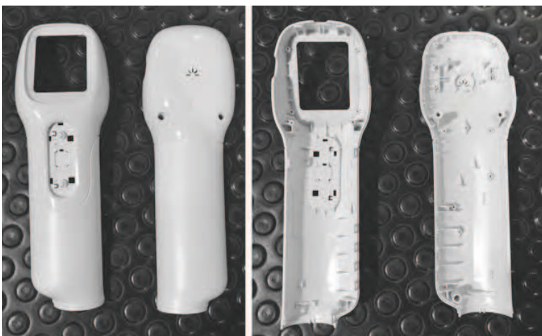
Fig. 2 - Interno ed esterno delle due parti che compongono l'involucro del dispositivo.
