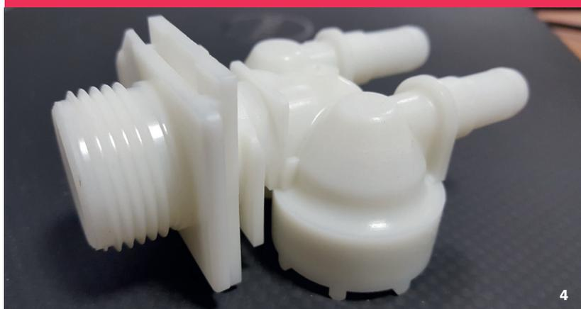
**Il componente realizzato esclusivamente di fresatura grazie alla collaborazione con MMC Hitachi Tool: videata CAM (1), lavorazione (2), pezzo finito (3) e prodotto plastico realizzato (4).**
