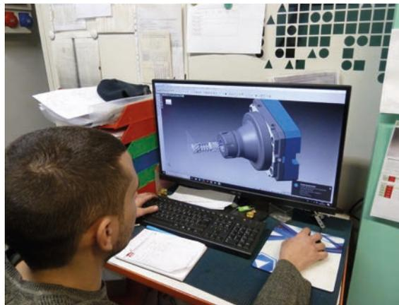
Il software della Vero combina VISI Modelling, un potente modellatore CAD bidimensionale e tridimensionale con motore Parasolid con il CAM VISI Machining, per la programmazione delle strategie di lavorazione da due assi e mezzo fino a cinque assi
