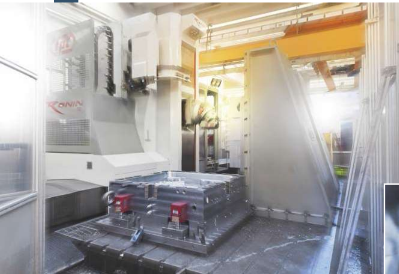
Tutte le lavorazioni meccaniche vengono eseguite con macchine utensili a controllo numerico, direttamente collegate alla progettazione, grazie a programmi gestionali avanzati (nella foto fresatrice a Montante Mobile FPT).
