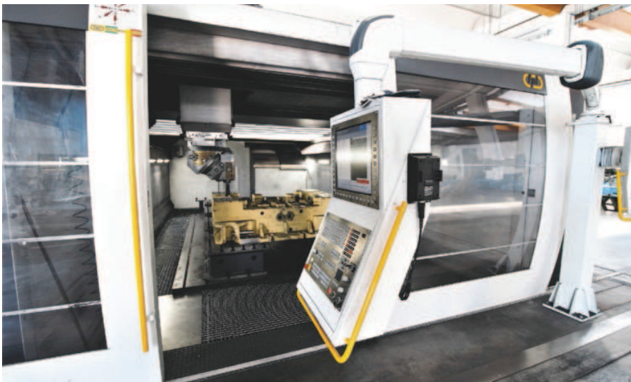
Stampo in lavorazione su delle macchine installate all'interno dello stabilimento di Ceggia.
