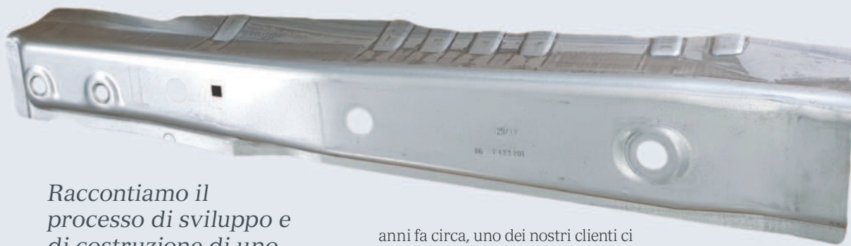
La traversa in lamiera, nella versione destra e sinistra.
