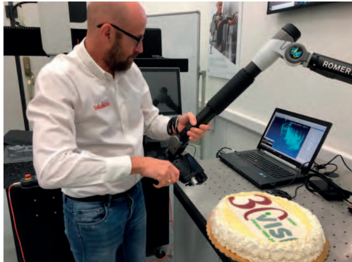
L'integrazione delle soluzioni VISI con il Romer Absolute Arm di Hexagon Manufacturing Intelligence, scansionando qualsiasi oggetto.
